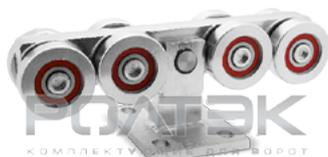
Опора МАКС Н – высокотехнологичное изделие, разработана выдерживать большие нагрузки, чем требуется для перемещения створки весом 2 тонны. Опоры в конструкции откатных ворот воспринимают нагрузки от створки ворот и передают их на фундамент. Совместно с направляющей обеспечивают перемещение створки.
